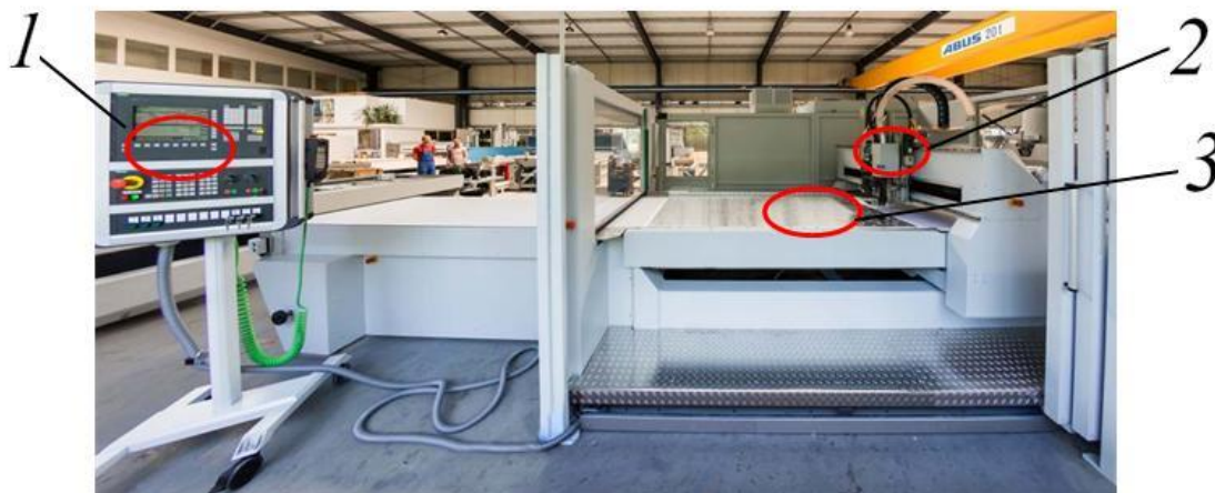
Рис. 2. Обрабатывающий центр PORTATEC: 1 – блок управления;
