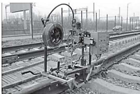
Рис. 5. Аппарат APC-4 для сварки рельсов и схема перемещения мундштука при электродуговой сварке рельсов ванным способом с использованием плавящегося мундштука Fig. 5. ARS-4 apparatus for welding rails and a diagram of contact tube motion under electric arc welding of rails by the bath method using a consumable contact tube
