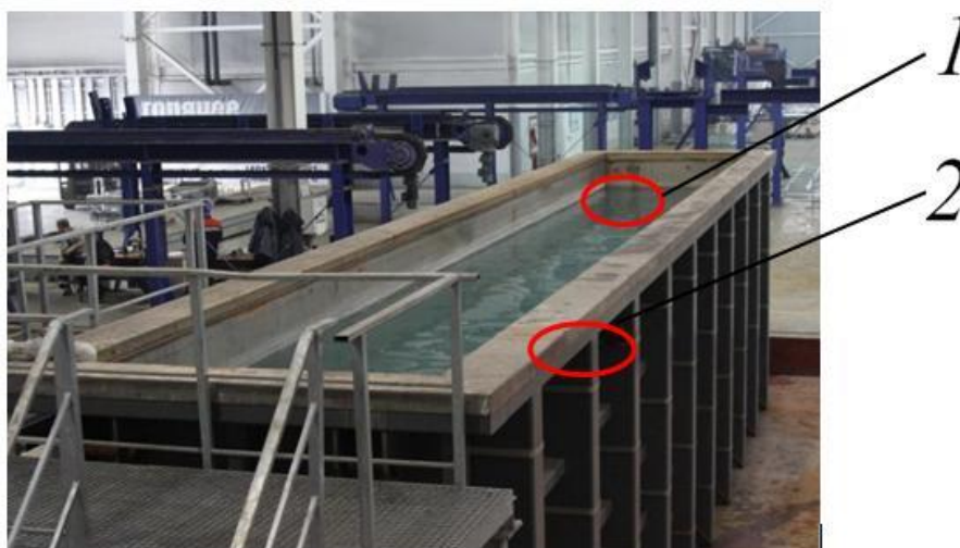
Рис. 1. Оборудование для размерного химического травления: 1 – ванна; 2 – травитель Fig. 1. Equipment for dimensional chemical etching: 1 – tank; 2 – etching agent
