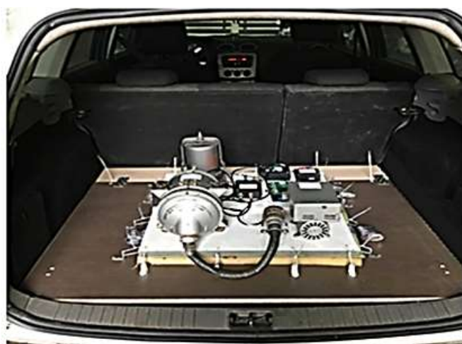
Рис. 2. Размещение измерительного комплекса с гироскопами в автомобиле
