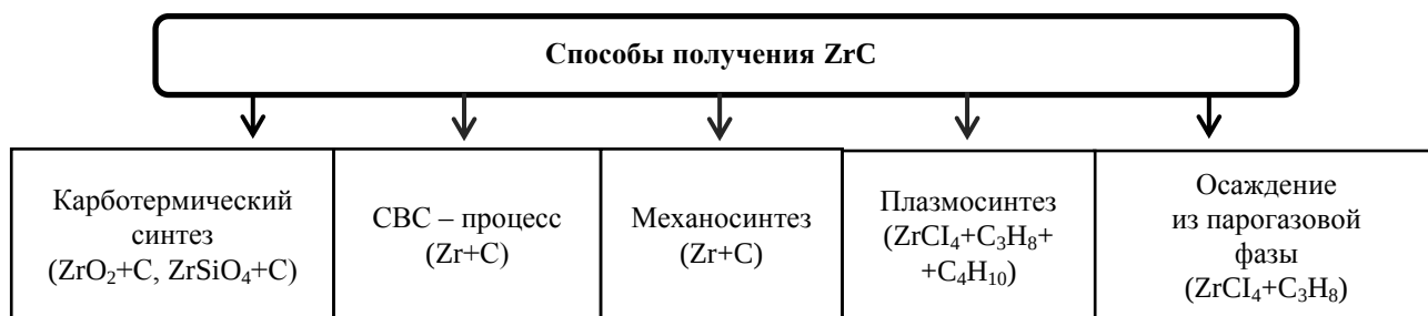
Рис. 1. Известные способы производства карбида циркония Fig. 1. Known methods of zirconium carbide production
