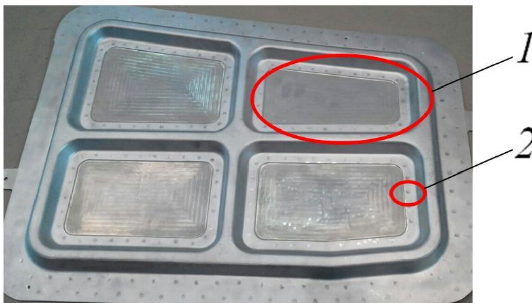
Рис. 5. Сварной образец, полученный из заготовок обшивки № 1 и элемента жесткости:
