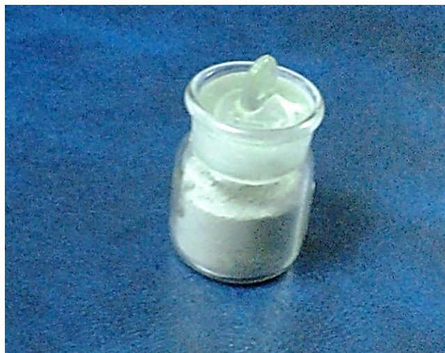
Рис. 3. Цинковый концентрат, полученный при переработке пылей электросталеплавильного производства Fig. 3. Zinc concentrate obtained in electrosmelting dust processing
