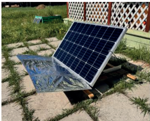
Рис. 3. Внешний вид исследуемого модуля на передвижной конструкции и отражателе Fig. 3. External view of the studied photovoltaic module on a mobile structure and a reflector
