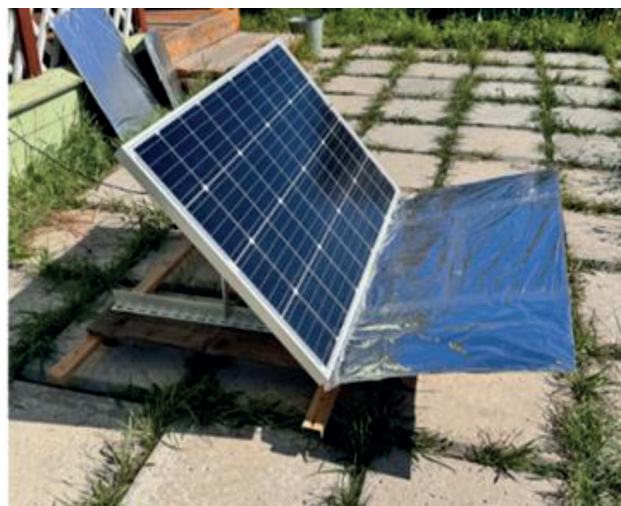
Рис. 3. Внешний вид исследуемого модуля на передвижной конструкции и отражателе Fig. 3. External view of the studied photovoltaic module on a mobile structure and a reflector
