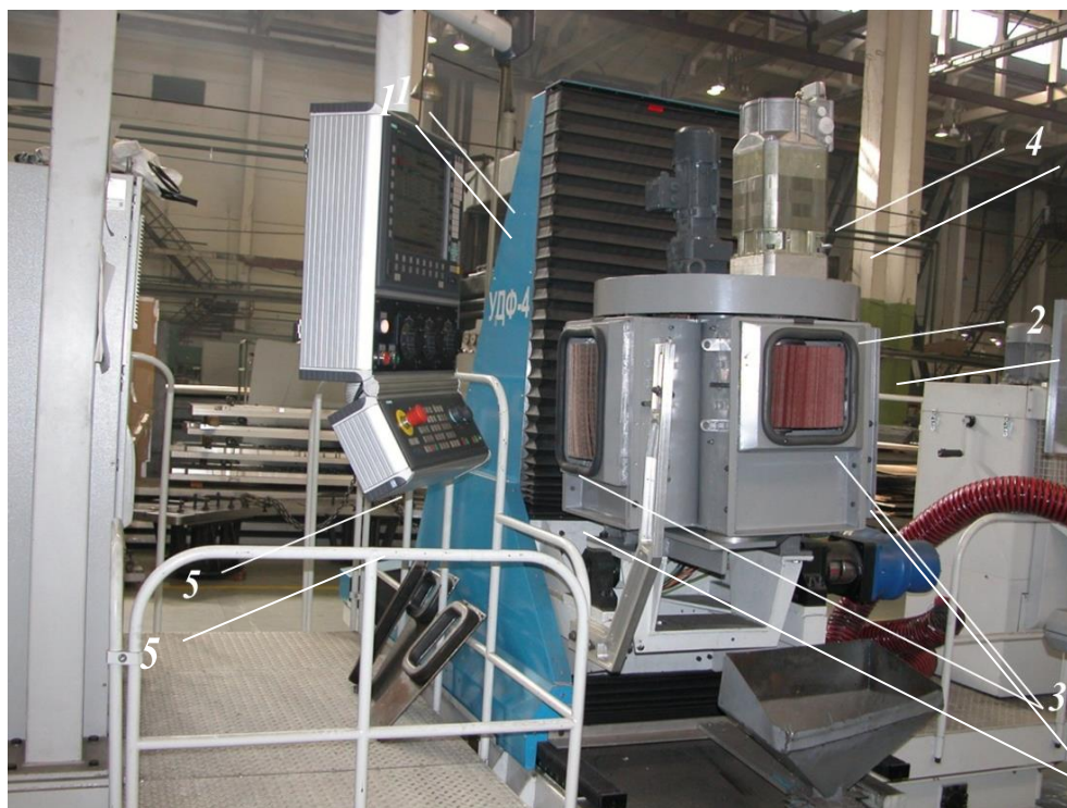
Рис. 1. Установка УДФ-4 с зачистной головкой револьверного типа ЗГР-1: 1 – установка УДФ-4; 2 – сменный рабочий орган установки, зачистная головка ЗГР-1; 3 – лепестковые круги; 4 – двигатель главного движения; 5 – пульт управления Fig. 1. UDF-4 installation with the grinding head of turret type ZGR-1, 1 – UDF-4 installation; 2 – removable effector, grinding head ZGR-1; 3 – flap wheels; 4 – main engine; 5 – control panel
