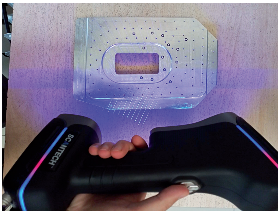
Рис. 1. Деталь «База люка» в процессе сканирования
