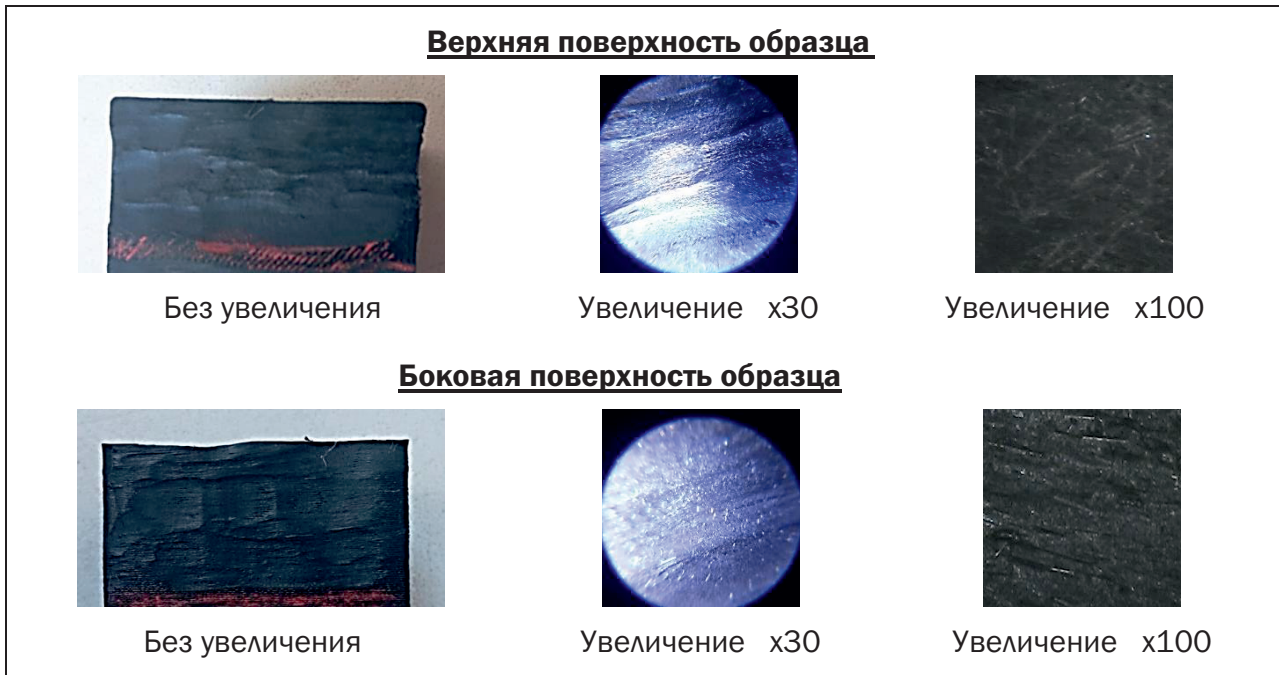
Рис. 5. Часть заготовки, обработанная полировальным кругом Fig. 5. Part of the workpiece machined with a polishing wheel
