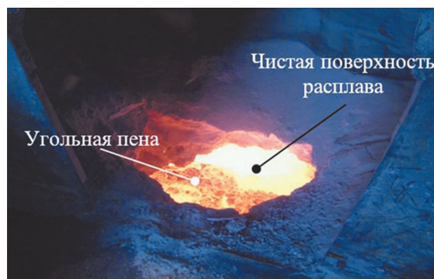
Рис. 3. Угольная пена в расплаве электролита [29] Fig. 3. Carbon skim in the electrolyte melt [29]
