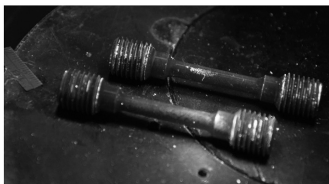
Рис. 2. Пропорциональный цилиндрический образец-свидетель: а – эскиз образца; б – образец-свидетель Fig. 2. Proportional cylindrical witness sample: a – sample diagram; b – part-sample
