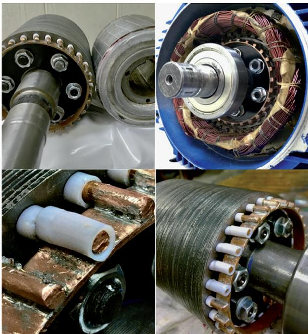
**Рис. 2.** Ротор экспериментального асинхронного двигателя
