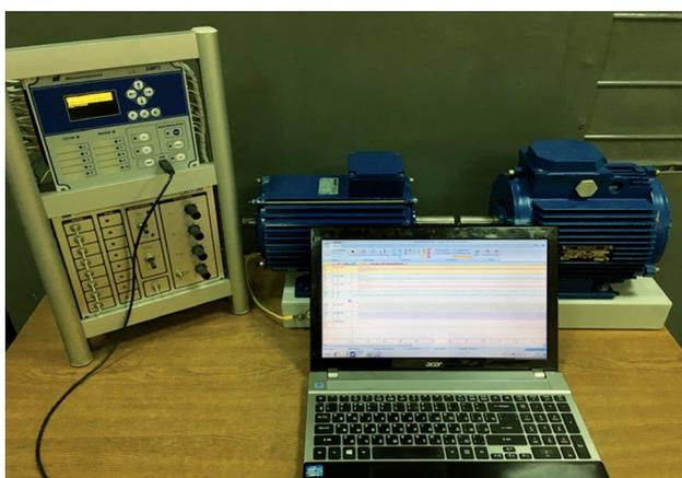
Рис. 4. Экспериментальная установка при получении сигнала токов статора от стандартизированного микропроцессорного блока релейной защиты и автоматики
