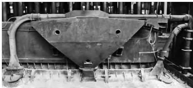
Рис. 2. Электролизер С-8БМ(Э), оборудованный четырехкупольной СГУ [14]
