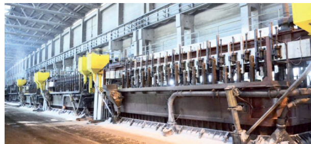
Рис. 3. Электролизер С-8БМ(Э), оборудованный автоматической подачей глинозема
