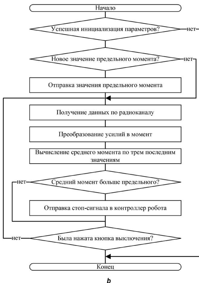
**Рис. 4. Блок-схемы алгоритмов разработанных систем: а – чувствительный элемент с передатчиком и индикацией; б – приемник, связанный с роботом-манипулятором**
