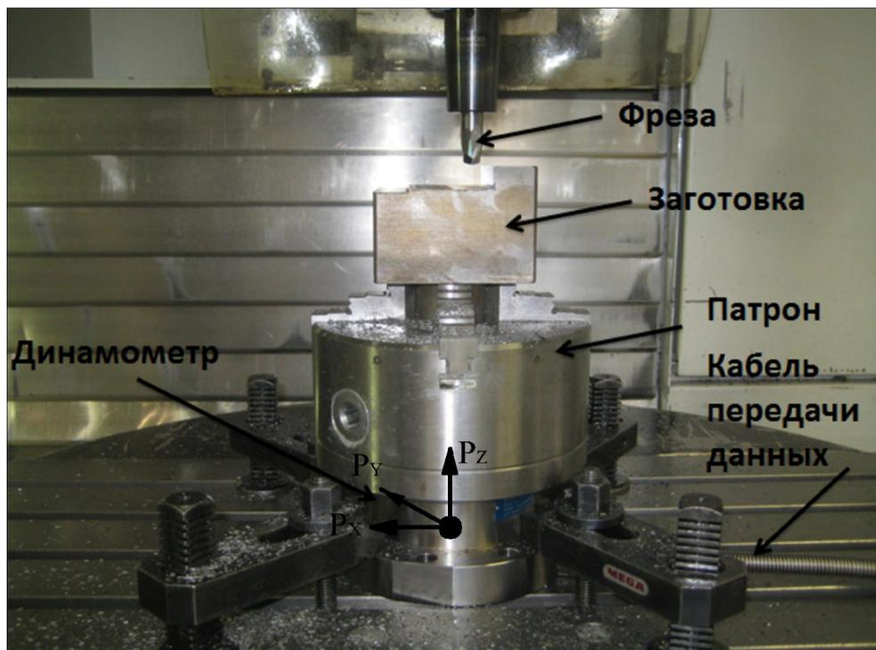
Рис. 2. Экспериментальная установка для исследования процесса резания вращающимся инструментом
