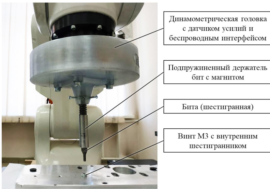
Рис. 2. Прототип специального исполнительного устройства, установленный на роботе KUKA KR3 R540
