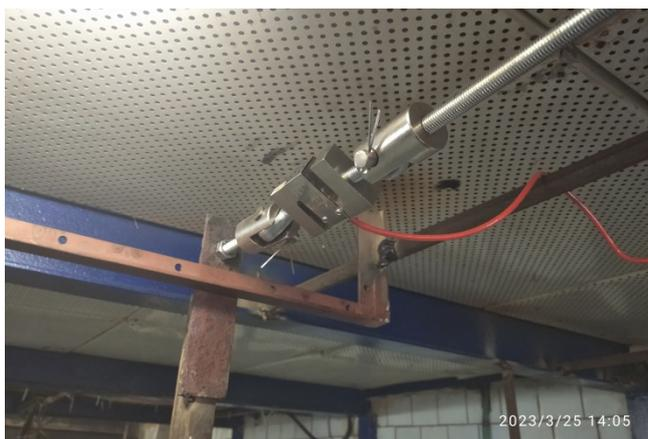
Рис. 5. Способ установки тензодатчика для измерения тормозного момента
