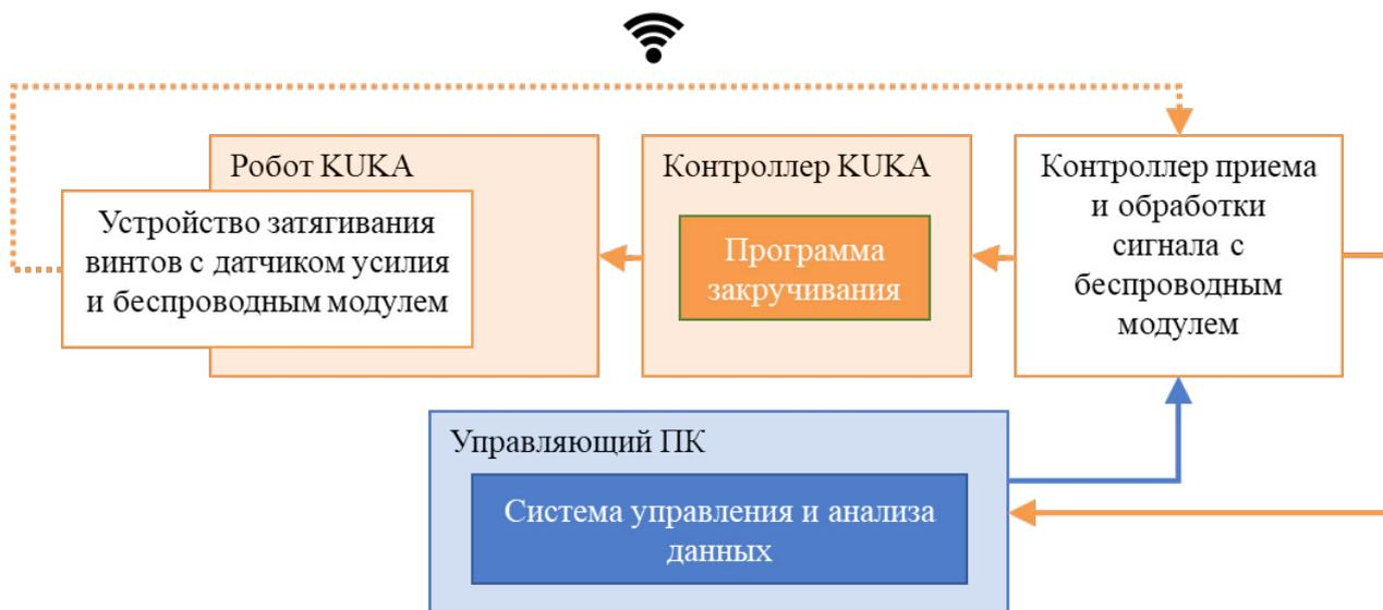
Рис. 3. Функциональная схема роботизированного устройства сборки винтовых соединений
