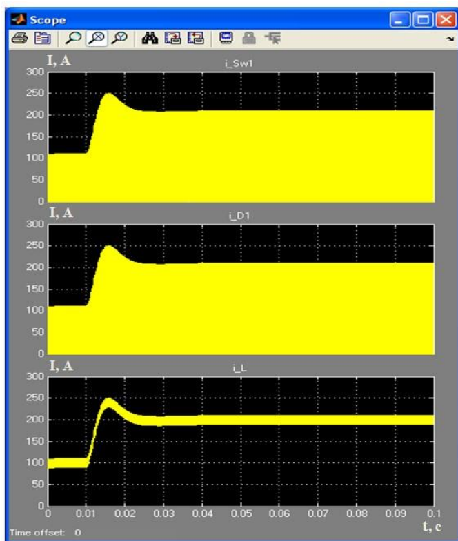
Рис. 30. Осциллограммы i_{Sw1} , i_{D1} , i_L отработки возмущения в виде скачкообразного уменьшения R_n до 0,5 Ом Fig. 30. Oscillograms of i_{Sw1} , i_{D1} , i_L of disturbance response in the form of a stepwise decrease of R_n to 0.5 Ohm
