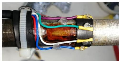
Рис. 17. Распайка и фиксация кабеля на резце со стороны тензорезисторов
