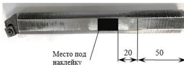
Рис. 14. Расточной резец S20R-SSSCR09 с разметкой под наклейку тензодатчиков
