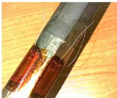
Рис. 16. Наклеенные тензорезисторы
