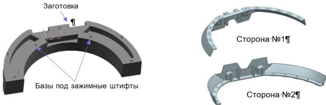
Рис. 3. Подготовка технологических баз
