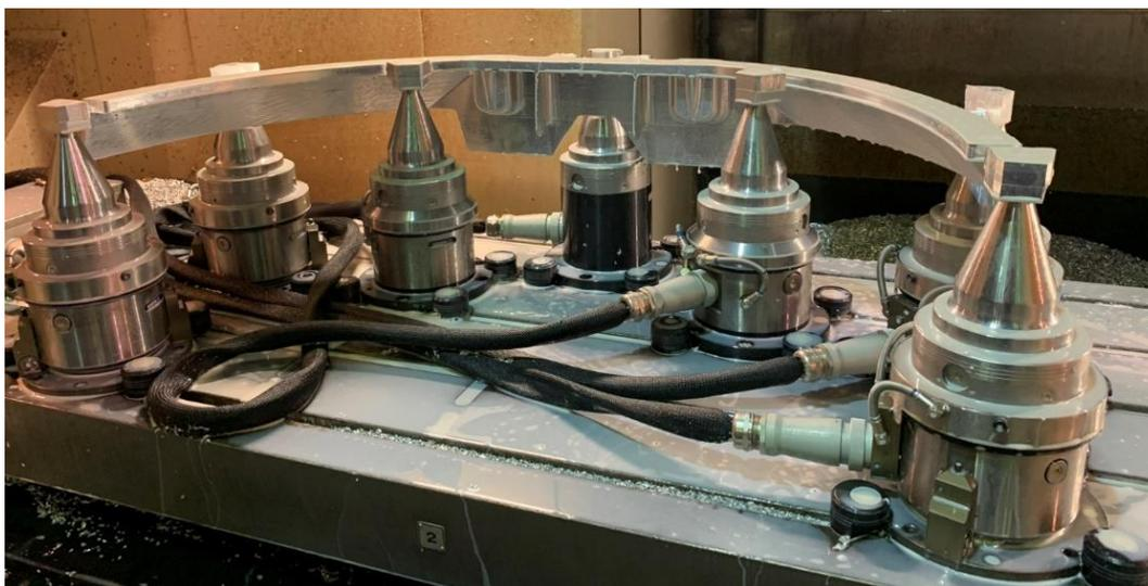
**Рис. 6. Закрепление заготовки при использовании оснастки VERO-S Aviation в процессе чистовой обработки поверхности № 1 детали типа «шпангоут»**
