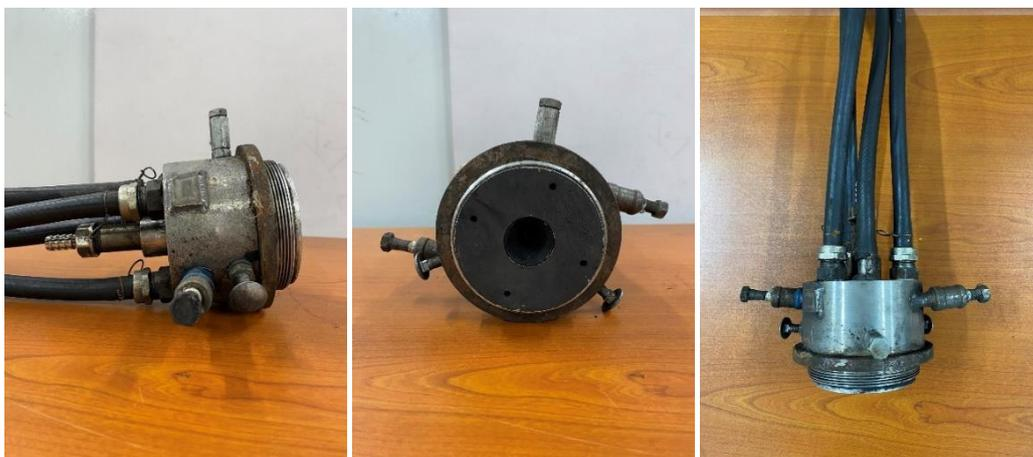
Рис. 6. Пневматическая форсунка
