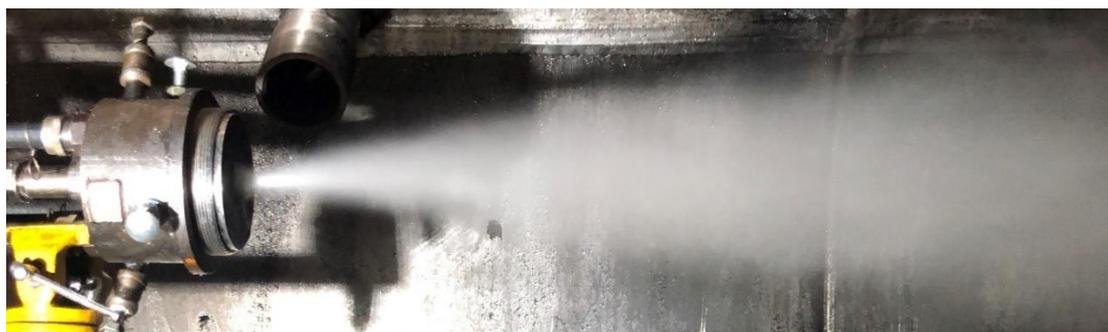
Рис. 7. Процесс распыления водоугольных суспензий
