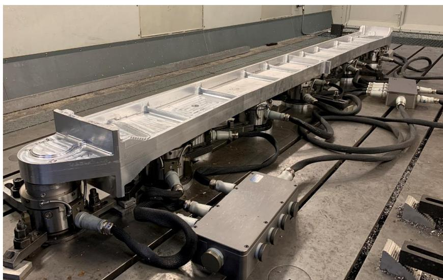
**Рис. 10. Производство детали типа «Балка» с применением оснастки SCHUNK VERO-S Aviation**
