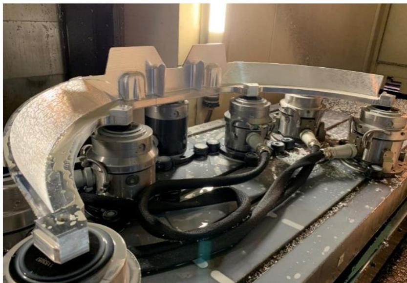
Рис. 5. Закрепление заготовки при использовании оснастки VERO-S Aviation в процессе черновой, получистовой и чистовой обработок поверхности № 2 детали типа «шпангоут»
