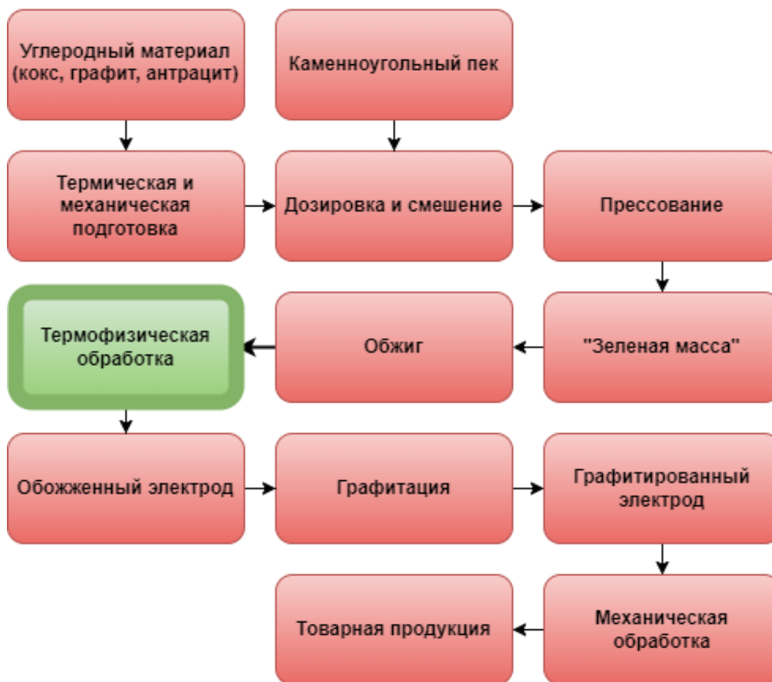
Рис. 7. Модернизированный цикл производства углеграфитовых электродов Fig. 7. Modernized carbon graphite electrode production cycle
