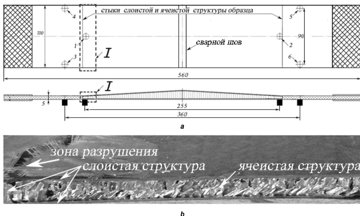
Рис. 1. Форма, габаритные размеры (а) и зона разрушения панели (b);
