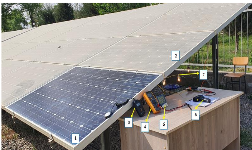
Рис. 1. Экспериментальная установка для определения генерации солнечного модуля в условиях г. Бохтар (Республика Таджикистан): 1 – очищенный солнечный модуль; 2 – запыленный солнечный модуль; 3 – цифровой люксметр MS6610; 4 – цифровой мультиметр CHYVictorVC890D; 5 – термометр/гигрометр TH90; 6 – инфракрасный термометр IR01D; 7 – галогенные лампы
