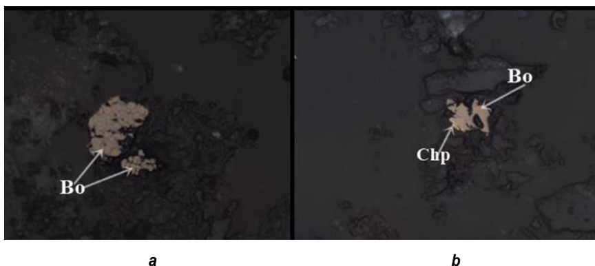
Рис. 5. Выделения борнита. Увеличение 200 (Bo – борнит, Chp – халькопирит) Fig. 5. Bornite segregations. 200×magnification (Bo – bornite, Chp – chalcopyrite)
