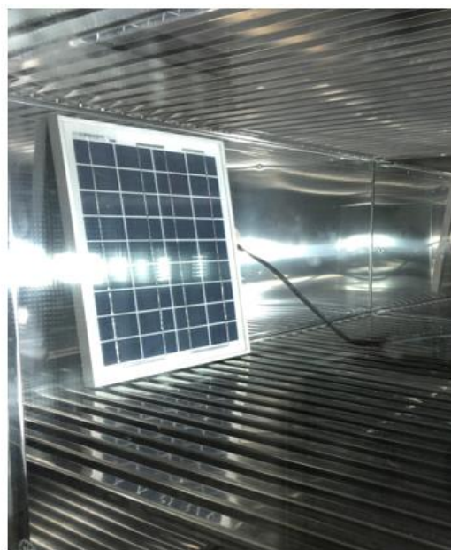
Рис. 1. Внешний вид фотоэлектрической установки внутри климатической камеры Fig. 1. External view of the photovoltaic installation inside the climate chamber
