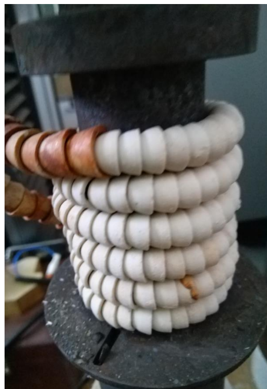
Рис. 4. Зона нагревателя на верхнем стержне установки Fig. 4. The heater zone on the upper rod of the installation
