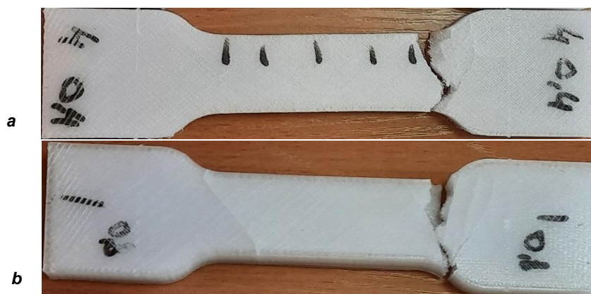
Рис. 5. Разрушенные FDM-образцы, напечатанные на 3d-принтере: a – толщина внешней оболочки 0,4 мм; b – толщина внешней оболочки 0,8 мм Fig. 5. Destroyed FDM samples printed on a 3d printer: a – outer shell thickness is 0.4 mm; b – outer shell thickness is 0.8 mm
