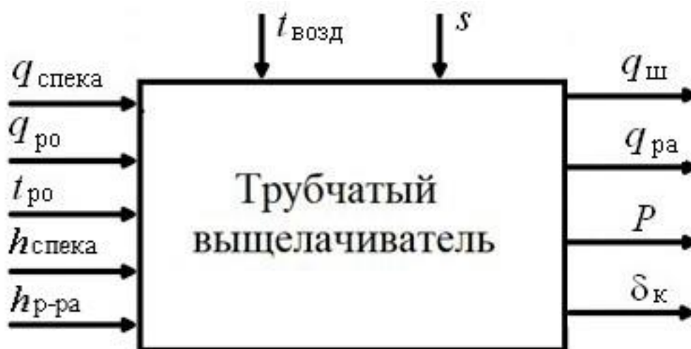
Рис. 2. Трубчатый выщелачиватель как объект управления Fig. 2. Tube digester as a control object
