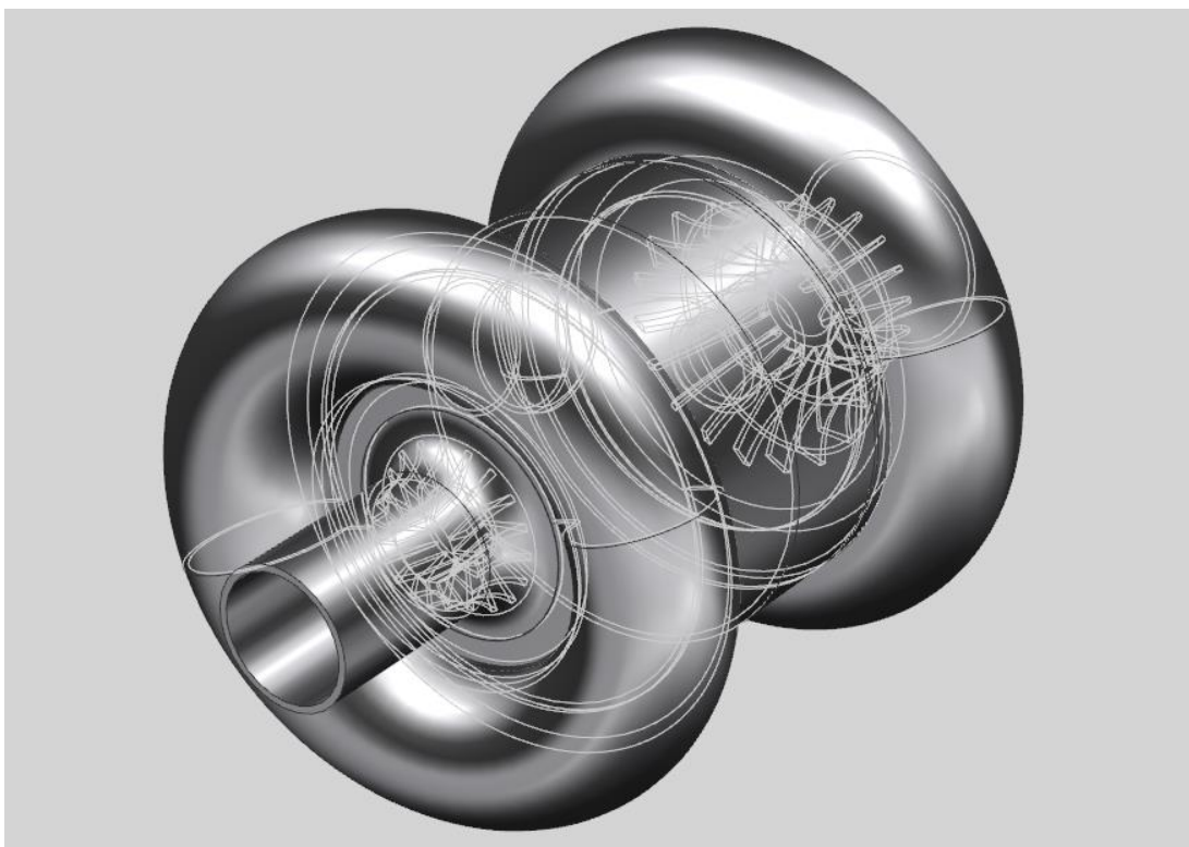
Рис. 13. Модель турбоохладителя с каркасным выделением невидимых элементов Fig. 13. Model of a cooling turbine with the frame selection of invisible elements
