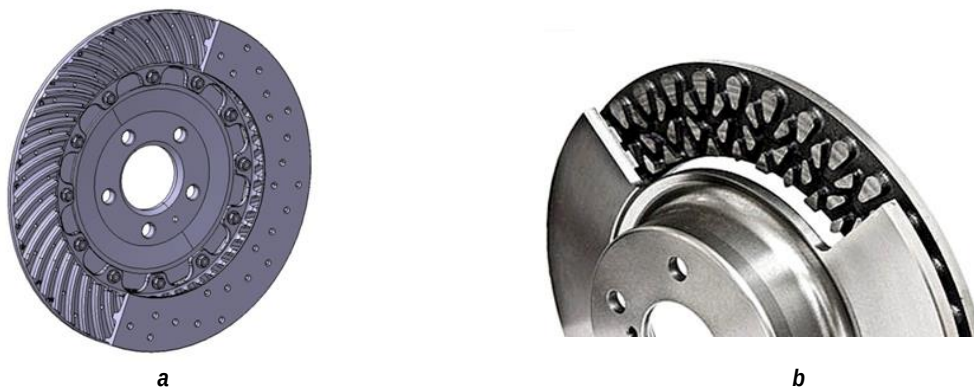
Рис. 1. Вентилируемые тормозные диски с оребренным (а) и сегментарным (b) узлами охлаждения Fig. 1. Ventilated brake discs with finned (a) and segmental (b) cooling units
