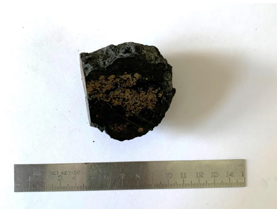
Рис. 2. Срез образца электросталеплавильного шлака Fig. 2. Section of a sample of electric steelmaking slag
