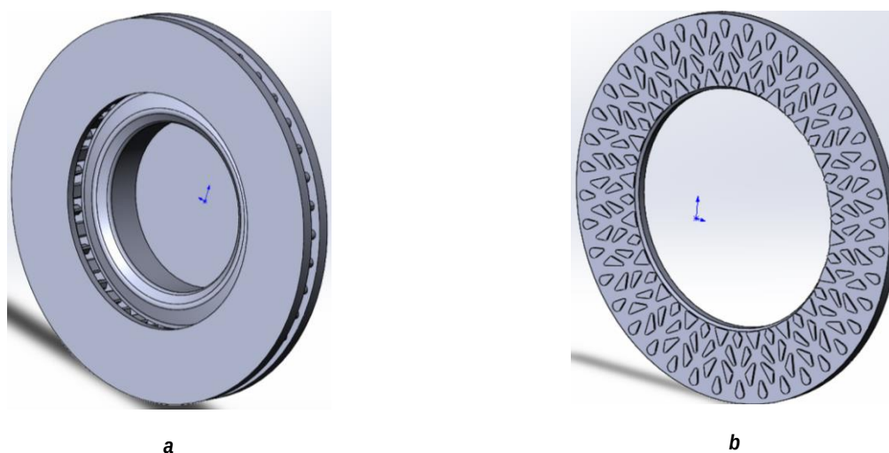
Рис. 5. Модель автоматизированного проектирования тормозного диска с сегментарным вентиляционным блоком: а – без надреза; б – с надрезом
