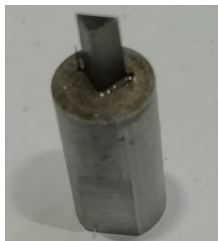
Рис. 15. Готовый пуансон Fig. 15. Finished punch
