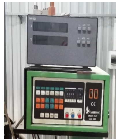
Рис. 6. Блок управления сервоприводами приспособления Fig. 6. Control unit of device's servo drives
