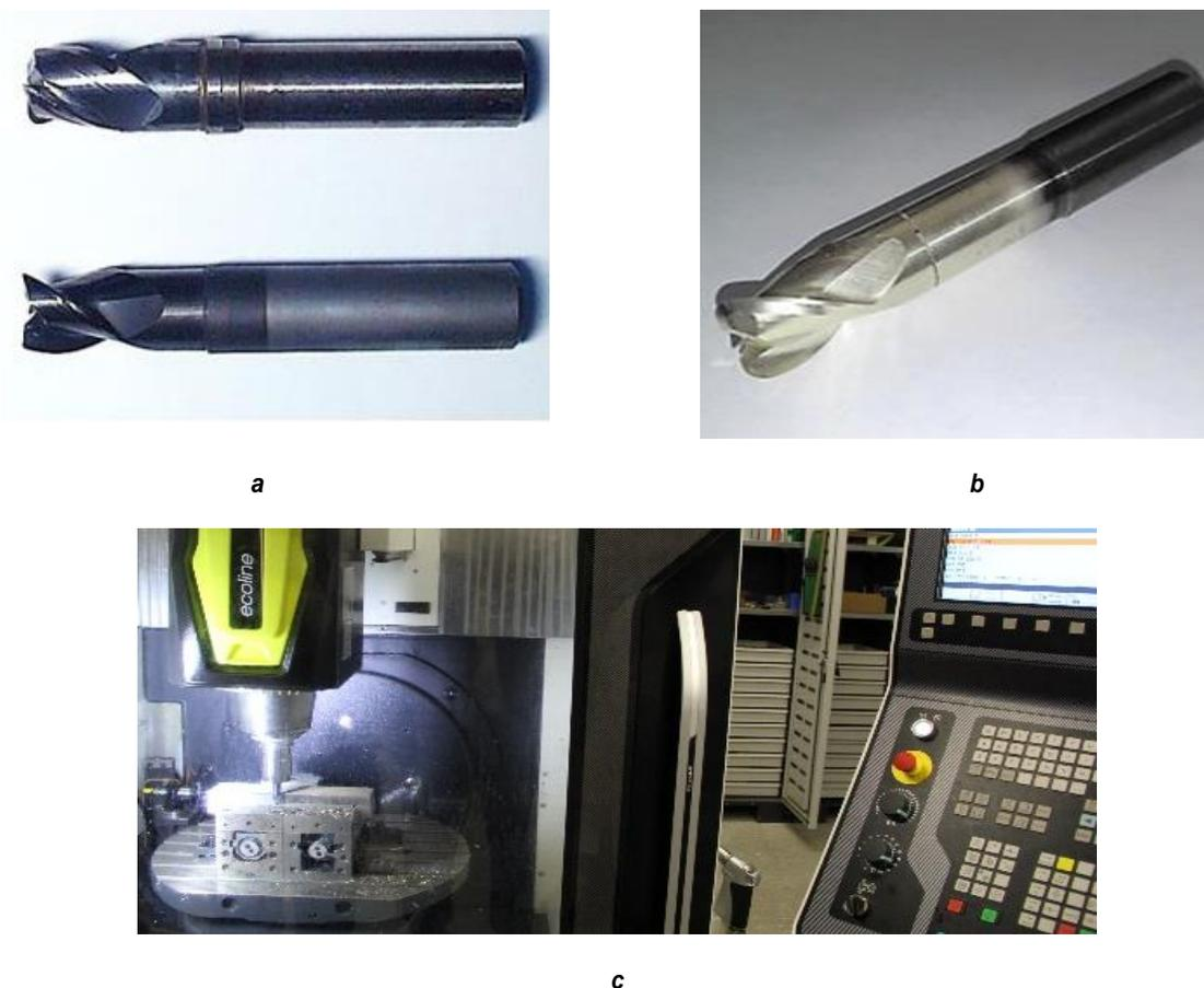
Рис. 1. Примеры составных концевых фрез: а, б – примеры фрез с покрытием, кольцевая канавка указывает место стыкования режущей части с хвостовиком; с – пример работы фрезой на станке с числовым программным управлением
