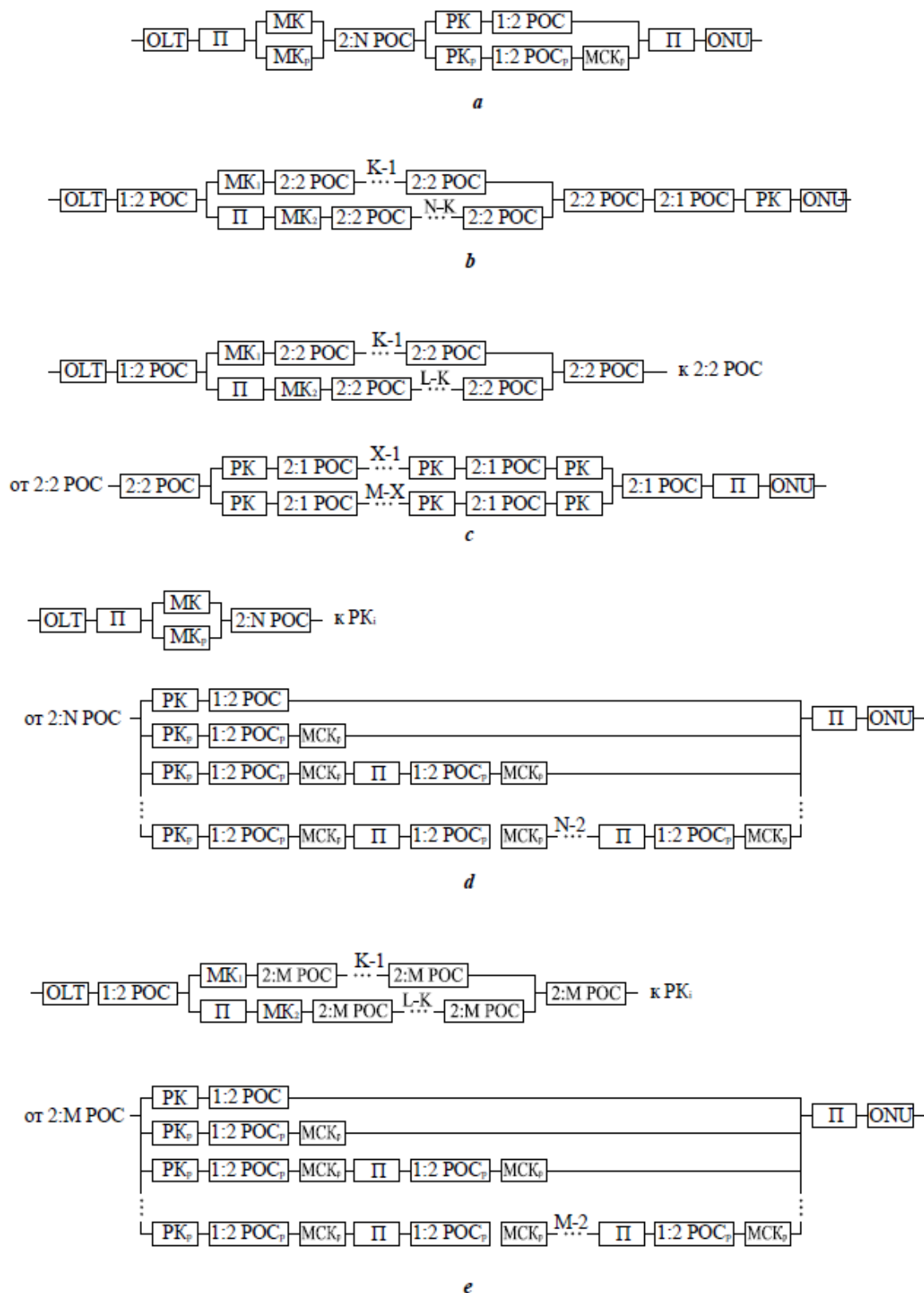
Рис. 17. RBD для схем: а – с «защитой соседа»; б – с защитой на основе одного кольца; с – с защитой на основе двойного кольца; д – с гибридной защитой на основе дерева; е – с гибридной защитой на основе кольца
