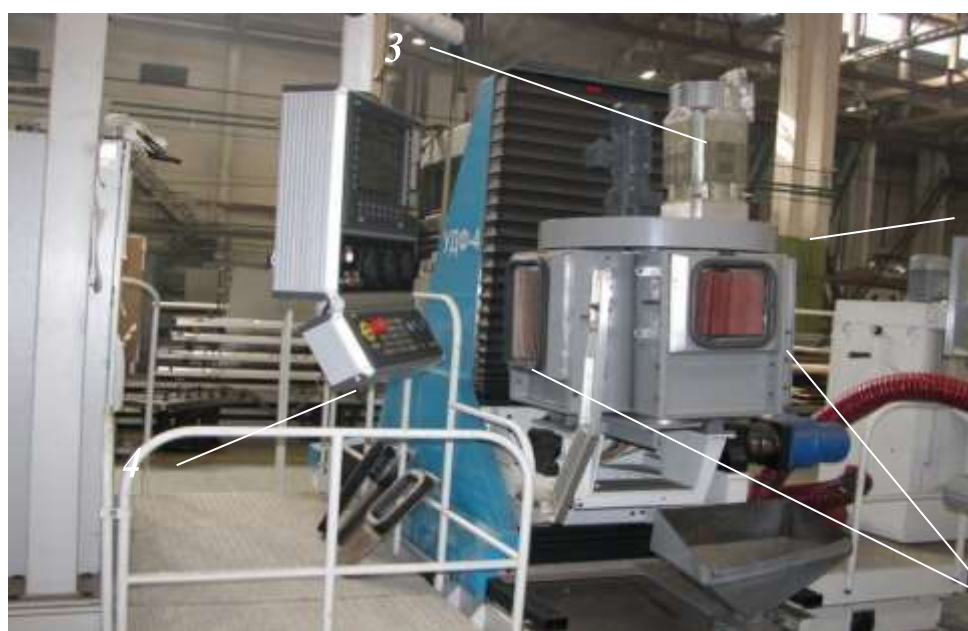
Рис. 1. Револьверная зачистная головка для зачистки криволинейных панелей самолета на установке УДФ-4: 1 – зачистная головка; 2 – лепестковые круги; 3 – двигатель главного движения; 4 – пульт управления
