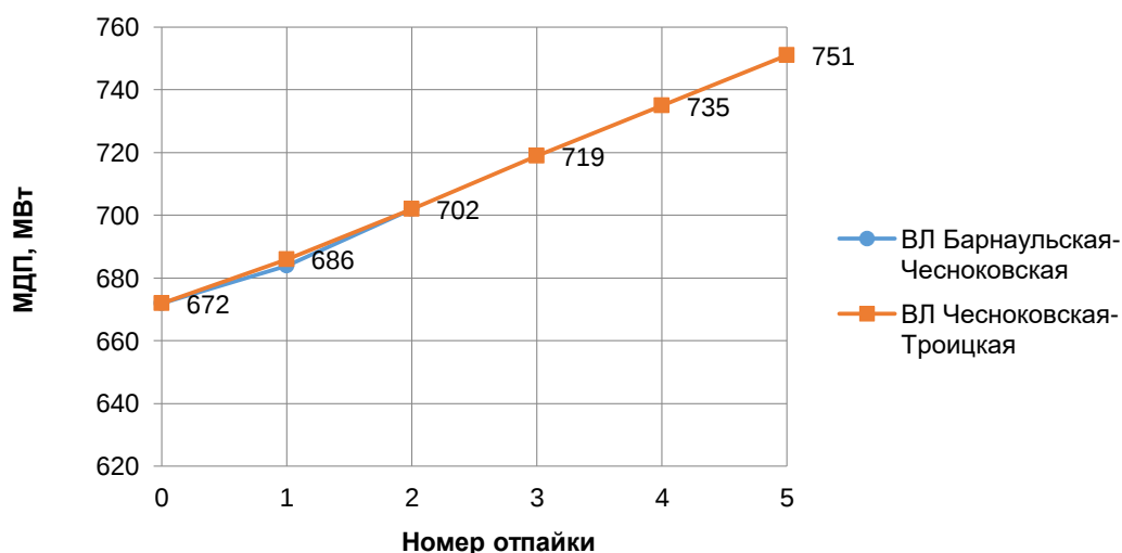
Рис. 3. Эффективность фазоповоротного трансформатора в послеаварийном режиме (отключение линии Чесноковская – теплоэлектроцентрали Алтайского коксохимического завода) Fig. 3. Efficiency of the phase-shifting transformer in the post-emergency mode (disconnected Chesnokovskaya – cogeneration plant of Altai Coke Plant line)
