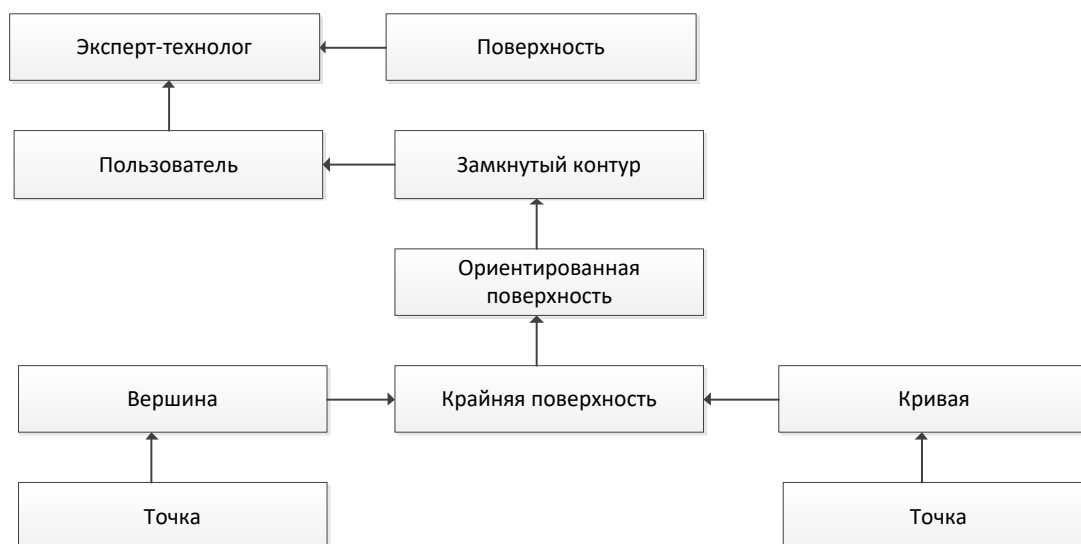
Рис. 2. Электронное представление 3D-модели изделия Fig. 2. Electronic representation of the product 3D model
