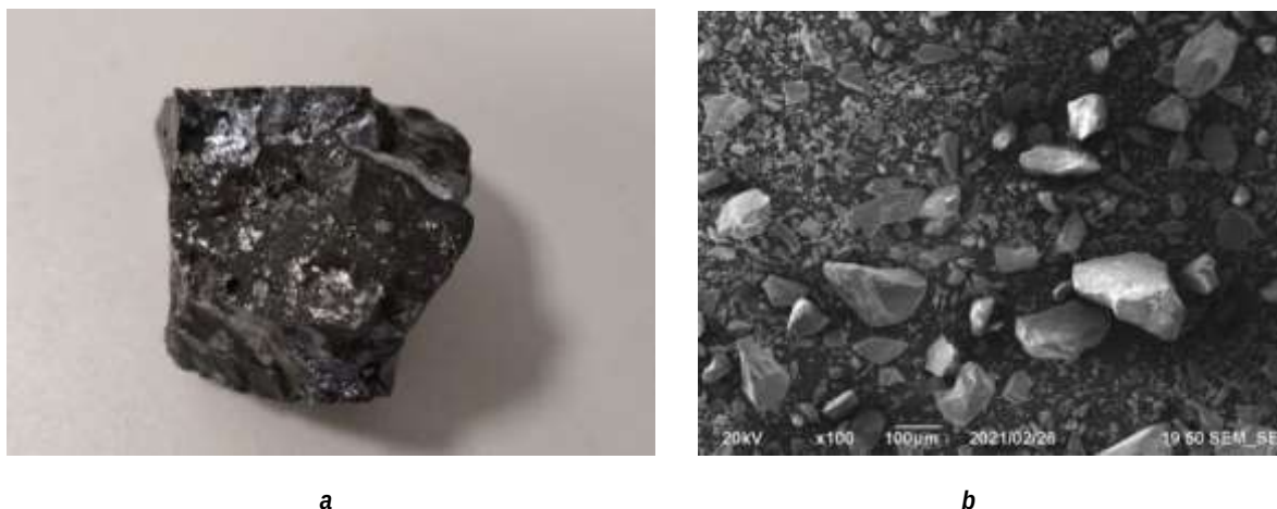
Рис. 2. Рафинировочный шлак кремниевого производства в АО «Кремний»: а – общий вид; b – фото измельченного образца шлака (сканирующая электронная микроскопия, увеличение x100) Fig. 2. Refinery slag of silicon production at Silicon JSC: a – general view; b – image of a crushed slag sample (scanning electron microscopy, 100x magnification)
