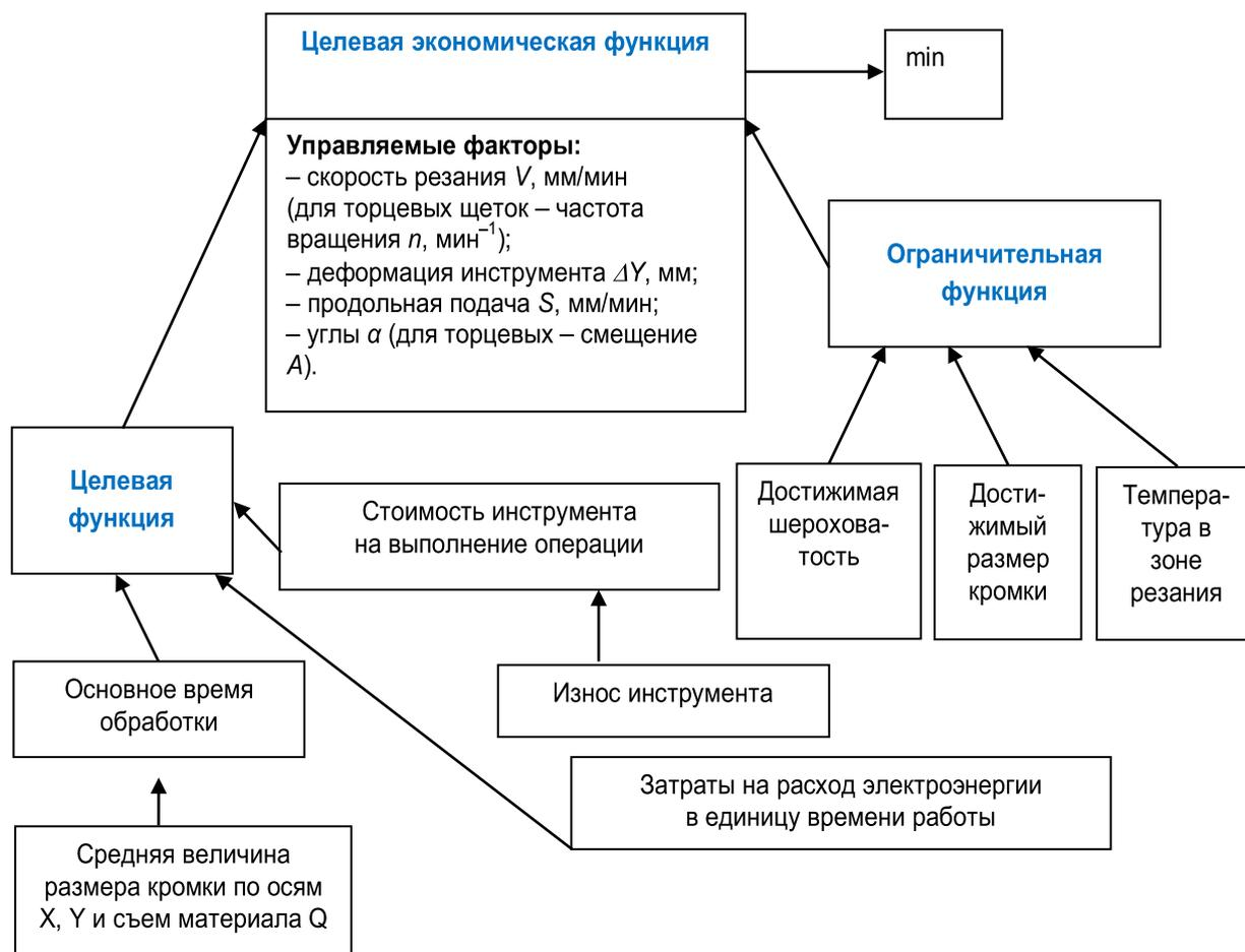
Рис. 2. Структура подсистемы оптимизации скругления кромок эластичными полимерно-абразивными щетками
