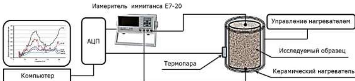
Рис. 1. Экспериментальная установка для измерения электрофизических характеристик
