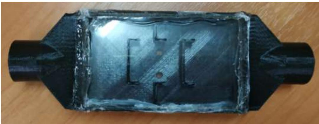
Рис. 4. Фотография устройства с П-образными элементами, предназначенного для разделения эмульсий
