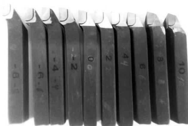
Рис. 2. Токарные подрезные отогнутые резцы
