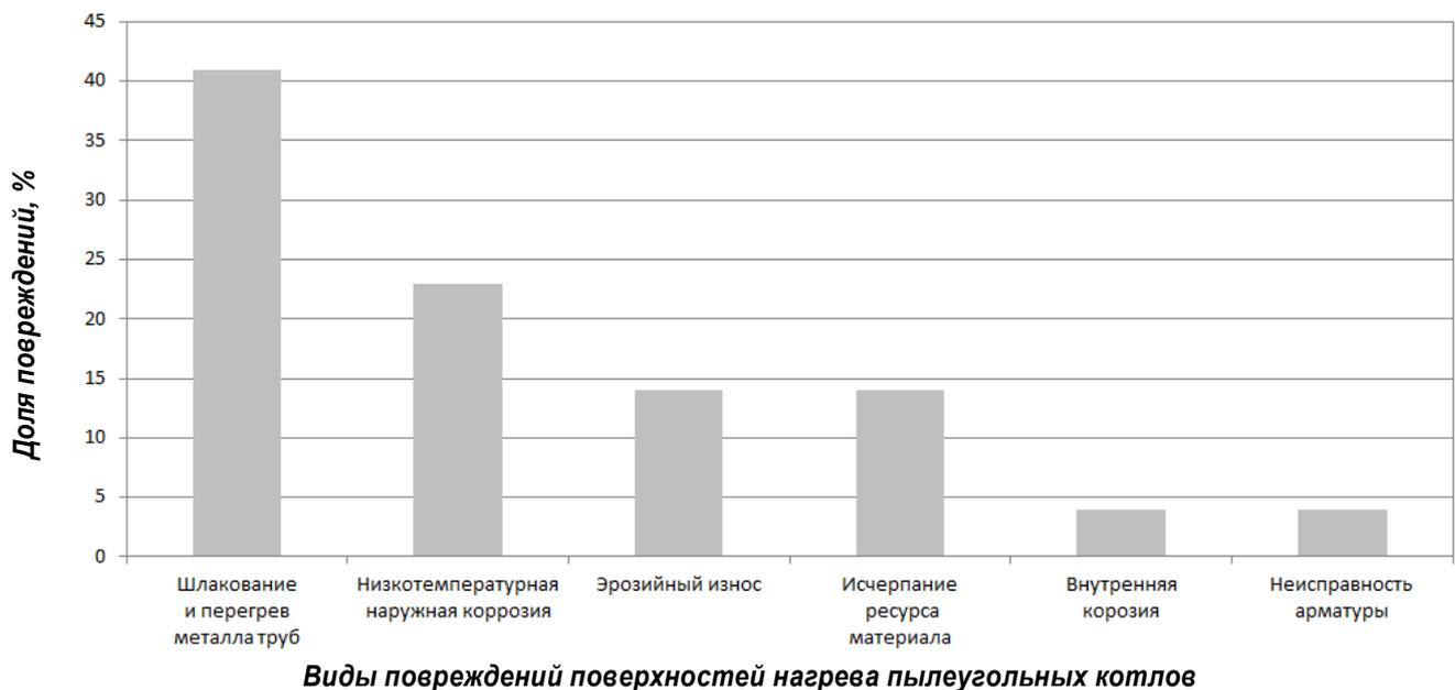
Рис. 2. Статистика причин повреждений поверхностей нагрева пылеугольного котла
