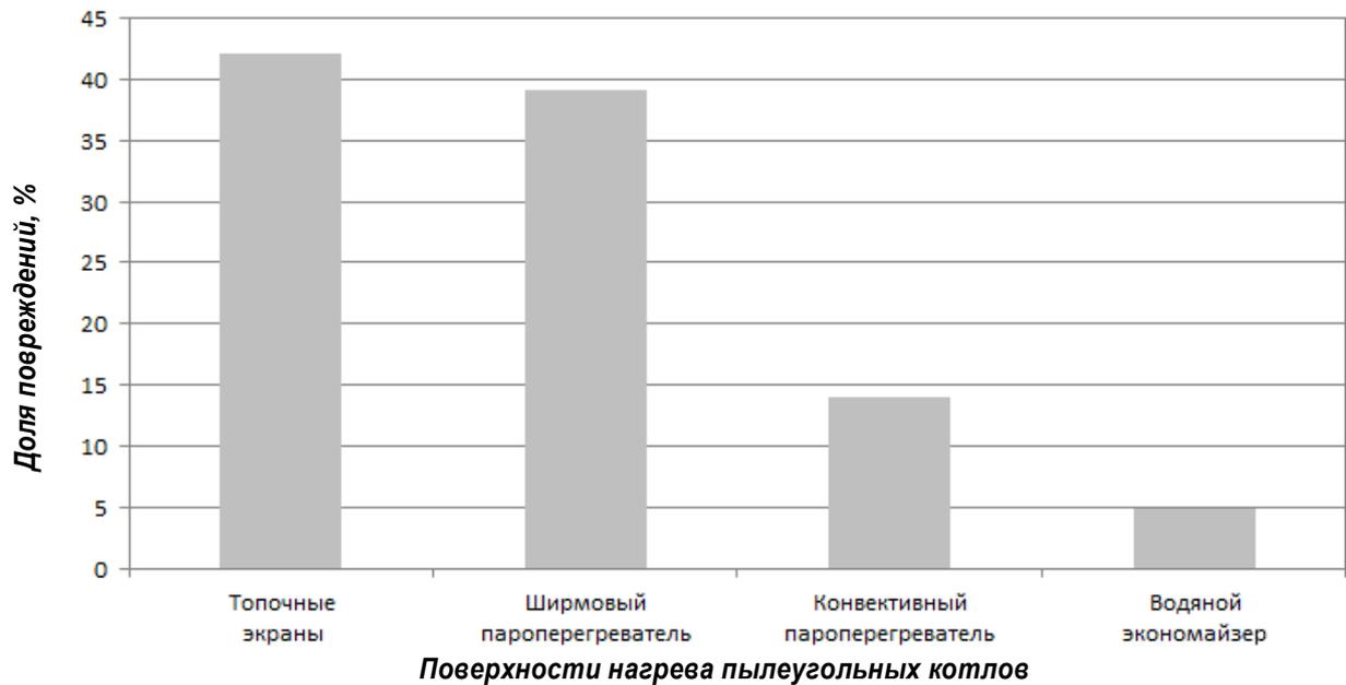
Рис. 1. Статистика повреждений поверхностей нагрева пылеугольного котла
