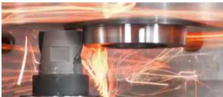
Рис. 2. Процесс ротационного точения на токарном станке серии UNIVERTOR AC-1
