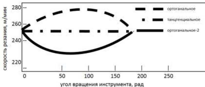
Рис. 7. Сравнение скоростей резания
