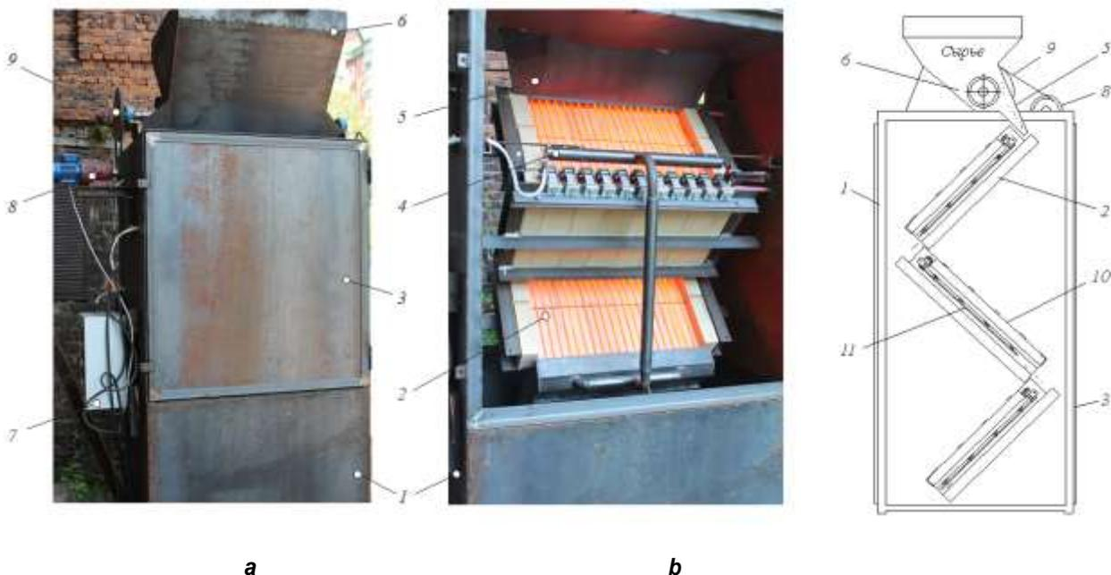
Рис. 1. Электрическая печь: 1 – корпус, 2 – модуль, 3 – дверца, 4 – пылеуловитель, 5 – лоток, 6 – барабанный дозатор, 7 – тиристорный регулятор, 8 – привод дозатора, 9 – ременная передача, 10 – термокрышка модуля (на рис. 1 а термокрышки сняты), 11 – проволочный электрический нагреватель (рис. 1 б)
