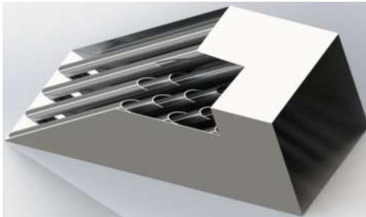
**Рис. 1. Трехмерная модель сепаратора (вид с разрезом). Движение газовых выбросов происходит справа налево**
