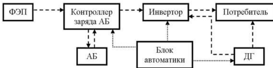
Рис. 2. Структурная схема автономного энергетического комплекса ФЭП–АБ–ДГ: пунктирные линии – потоки энергии, циркулирующие между элементами системы;
