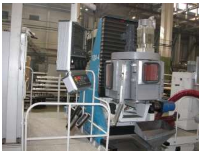
Рис. 1. Револьверная зачистная головка для зачистки криволинейных панелей самолета на установке УДФ-4
