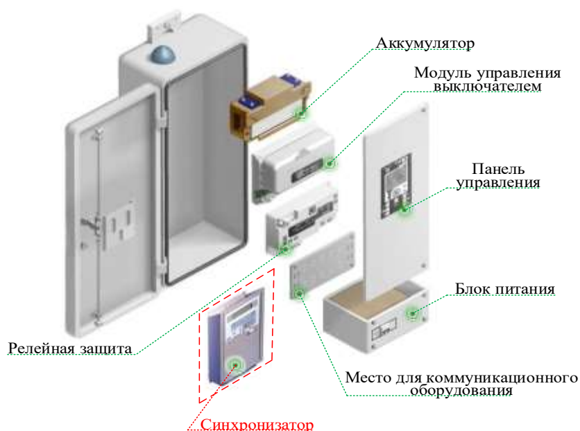
Рис. 7. Шкаф управления вакуумным выключателем с добавлением синхронизатора Fig. 7. Control cabinet of the vacuum circuit breaker with added synchronizer
