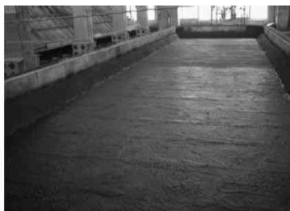
Рис. 9. Катод с покрытием TiB_2 по технологии «Ambient Temperature Cured» Fig. 9. TiB_2 coated cathode using Ambient Temperature Cured technology
