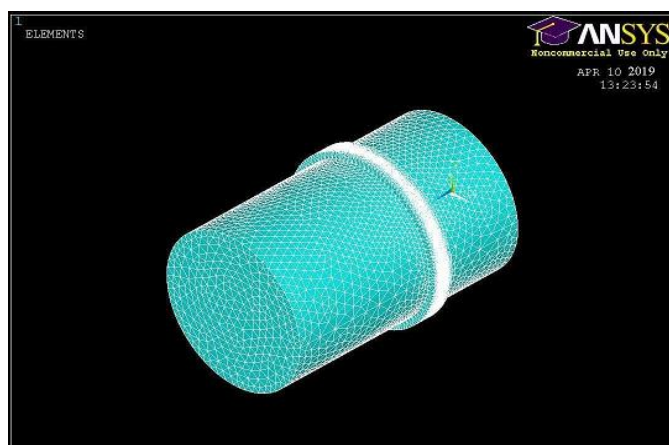
Рис. 3. Конечно-элементная модель редуктора Fig. 3. Finite element model of the reducer
