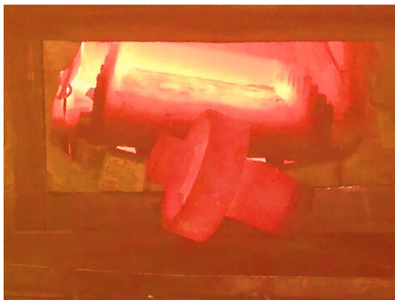
Рис. 3. Готовая деталь «ролик печной» Fig. 3. Finished part “kiln roller”
