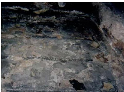
Рис. 8. Вид подины 1-го электролизера после периода работы 21 сут Fig. 8. View of the 1st cell bottom after the operation period of 21 days
