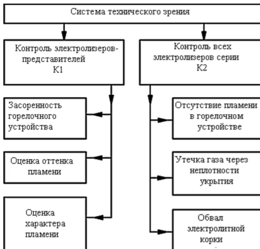
Рис. 3. Схема автоматизированного мониторинга на участке электролизеров Содерберга Fig. 3. Diagram of automated monitoring on the site of Söderberg cells
