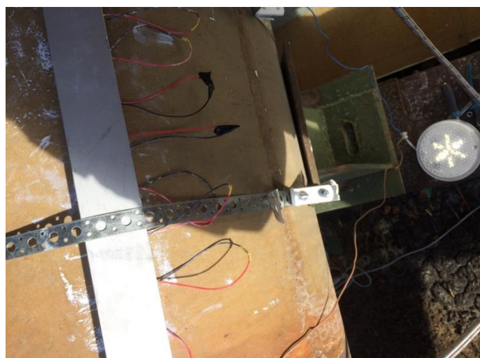
Рис. 4. Работа светодиодного фонаря, запитанного от блока термоэлектрического преобразования Fig. 4. Operation of a LED flashlight powered by a thermoelectric conversion unit
