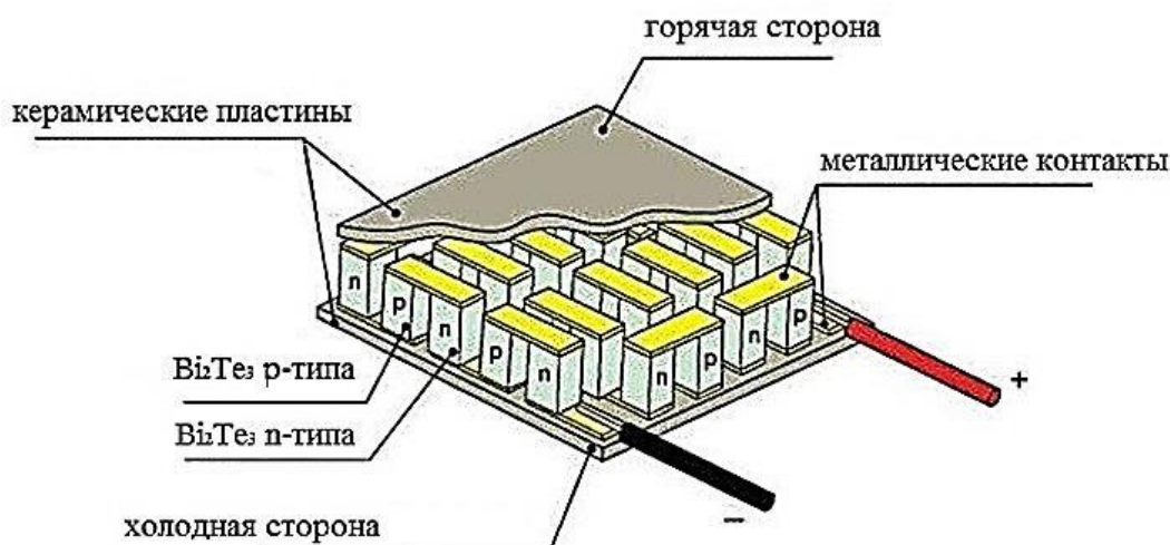
Рис. 1. Термоэлектрический модуль термоэлектрического преобразования Fig. 1. Thermoelectric module of thermoelectric conversion
