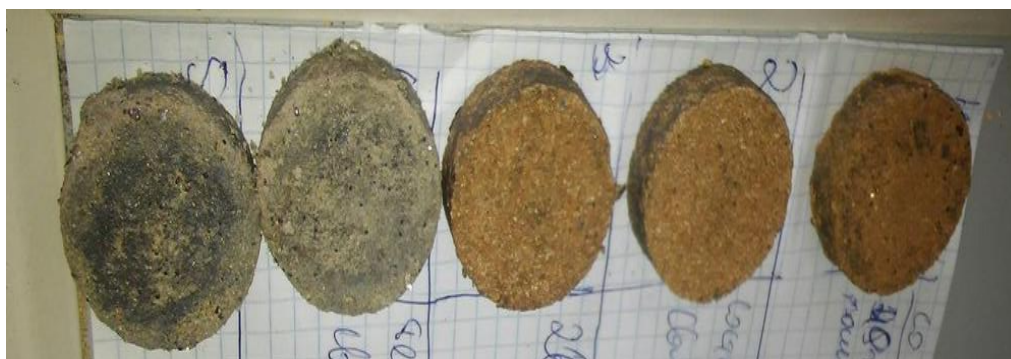
Рис. 1. Образцы для исследования на прочность, изготовленные с использованием глин различных месторождений: два образца слева изготовлены с глиной месторождения Белое Глинище Fig. 1. Strength test samples made of clays from various fields: two samples at the left are made of clay from Beloe Glinishche field
