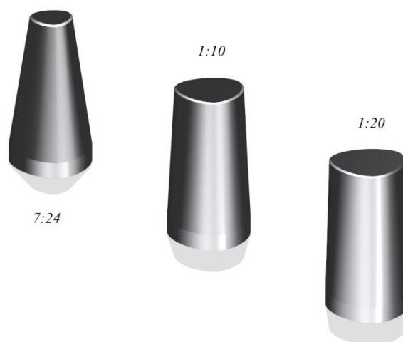
Рис. 4. Модели конических хвостовиков оправок с равноосным контуром посадочной поверхности Fig. 4. Models of conical shank mandrels with an equiaxial contour of a mounting surface
