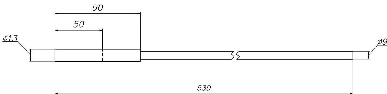
Рис. 1. Внешний вид и габаритные размеры стального стержня-кристаллизатора Fig. 1. Physical configuration and dimensions of the steel rod – crystallizer
