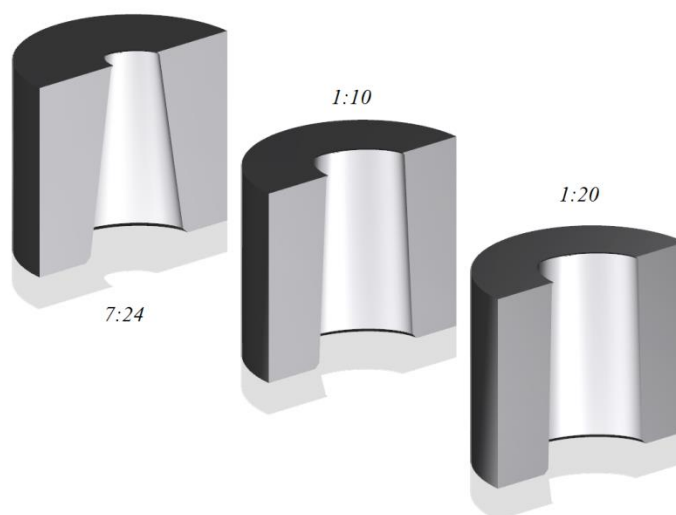
Рис. 5. Модели шпинделей с коническими профильными посадочными отверстиями с равноосным контуром Fig. 5. Models of spindles with conical profile mounting openings with an equiaxial contour
