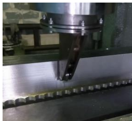
Рис. 14. Накатка внутренней полости Fig. 14. Knurling of internal cavity
