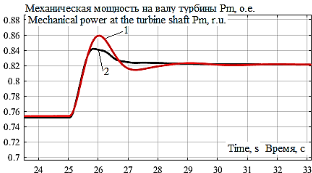
Рис. 9. Изменение механической мощности на валу турбины ТГУ при отключении источника питания: 1 – несогласованная настройка АРВ и АРЧВ (перерегулирование \sigma = 4,88\% , время переходного процесса t_p = 3 с); 2 – согласованная настройка АРВ и АРЧВ ( \sigma = 2,44\% , t_p = 3 с)
