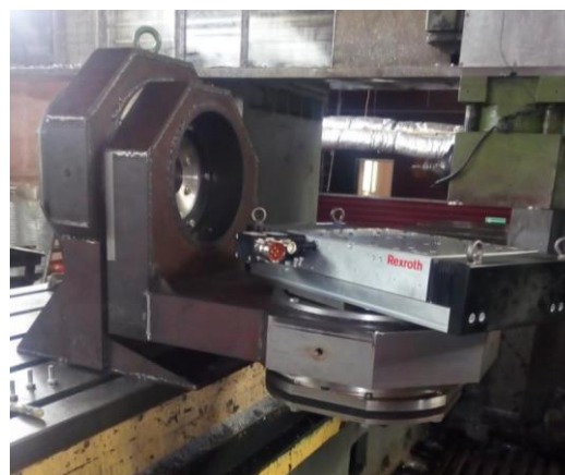
Рис. 15. Специальная трехосевая шпиндельная головка (без мотор-шпинделя) Fig. 15. Special three-axis spindle head (without a motor spindle)
