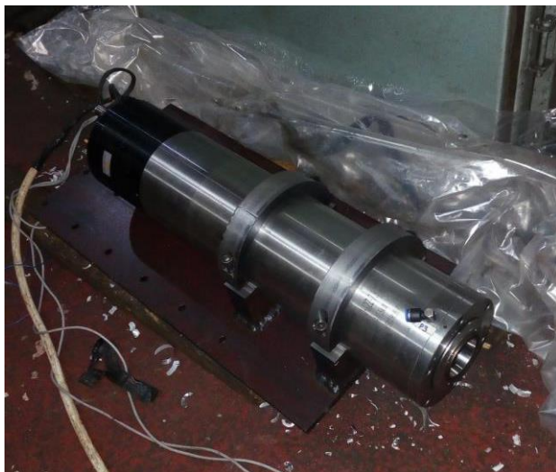
Рис. 7. Мотор-шпиндель с модулем крепления Fig. 7. Motor-spindle with a mounting module
