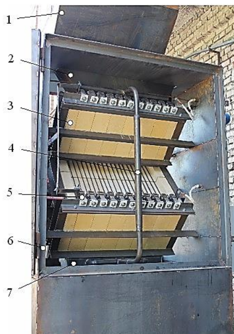
Рис. 1. Электрическая модульно-спусковая печь: 1 – дозатор сырья, 2 – лоток, 3 – модуль обжига, 4 – воздуховод, 5 – крепления электронагревателей, 6 – корпус печи, 7 – дополнительный неэлектрический модуль
