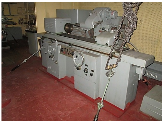
Рис. 1. Общий вид рейдовой плавучей мастерской и круглошлифовальный станок на ее механообрабатывающем участке Fig. 1. General view of the raid floating workshop and a cylindrical grinding machine in workshop machining area
