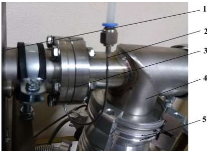
Рис. 3. Экспериментальный стенд для испытания медного кольца на герметичность:
