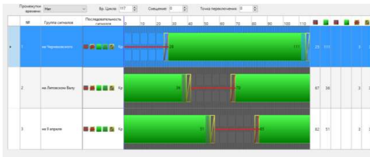
Рис. 3. Сигнальная программа кольцевого пересечения Fig. 3 Roundabout signal program
