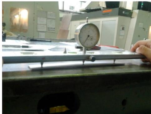
Рис. 4. Измерение прогиба пластины
