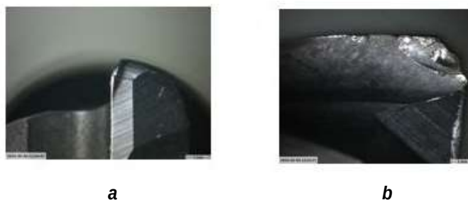
Рис. 4. А – износ зуба фрезы по задней грани; б – передняя поверхность зуба фрезы с элементами разрушения режущей кромки и налипом стружки Fig. 4. A – wear of the cutter tooth on the rear edge; b – front surface of the cutter tooth with the elements of cutting edge destruction and chip cakes
