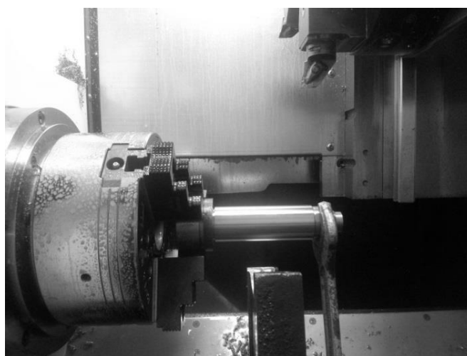
Рис. 2. Закрепление образцов-втулок в токарном обрабатывающем центре DMG NEF400 Fig. 2. Fixing of plug samples in the turning processing center DMG NEF400
