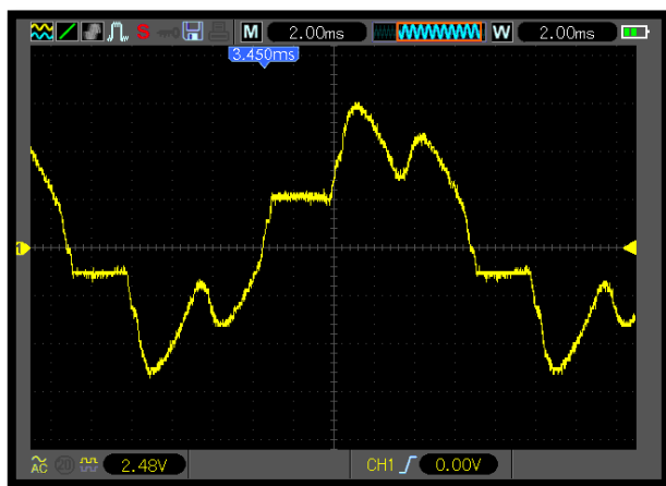
Рис. 2. Осциллограммы токов КТПН 6/0,4 на отходящих фидерах 0,4 кВ
