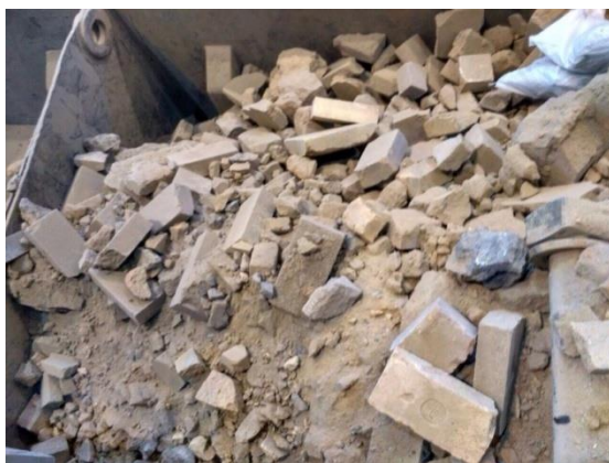
Рис. 1. Огнеупорная часть отработанной футеровки при демонтаже катодного устройства электролизера
