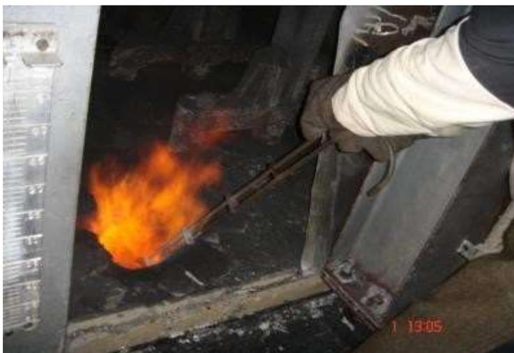
Рис. 5. Отбор проб электролита
