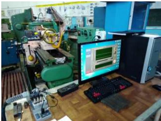
Рис. 1. Лабораторный стенд для исследования сил резания
