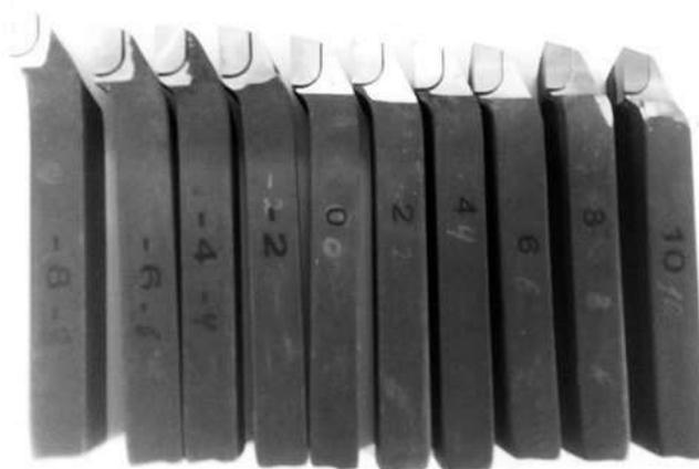
Рис. 2. Токарные подрезные отогнутые резцы
