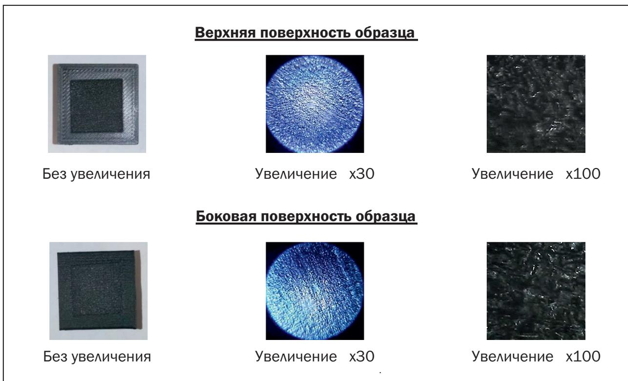
**Рис. 13.** Заготовка, обработанная лазерным излучением
