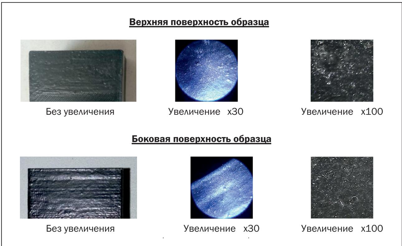
**Рис. 9.** Заготовка, обработанная дихлорметаном
