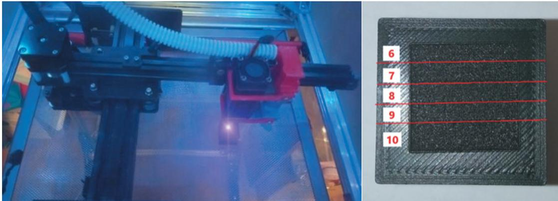
**Рис. 12.** Эксперимент с изменением скорости прохода лазера
