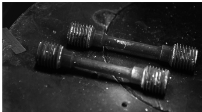
Рис. 2. Пропорциональный цилиндрический образец-свидетель: а – эскиз образца; б – образец-свидетель Fig. 2. Proportional cylindrical witness sample: а – sample diagram; б – part-sample
