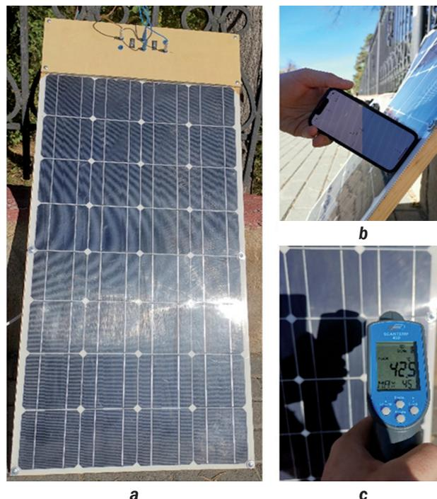
**Рис. 1.** Образец и условия проведения эксперимента для снятия вольт-амперных характеристик солнечного модуля: а – солнечный модуль BSP 32-100; б – угол наклона модуля к горизонту; с – пирометр PCE SCANTEMP 490
