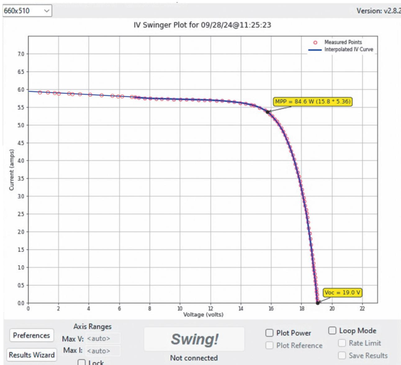
Рис. 3. Контрольная вольт-амперная характеристика модуля BSP 32-100
