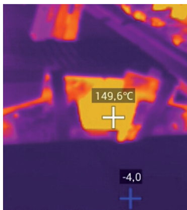
Рис. 6. Измерение температуры стандартной плавкой вставки с помощью тепловизора Flir T-430SC: а – до расшунтирования электролизера; б – после расшунтирования последнего анодного стояка
