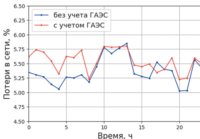
Рис. 10. Суточные графики потерь мощности в сети
