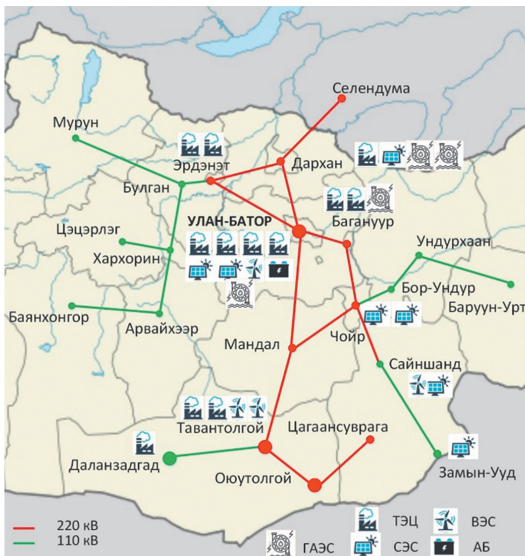
Рис. 8. Схема Центральной энергосистемы Монголии Fig. 8. Diagram of the Central Power System of Mongolia
