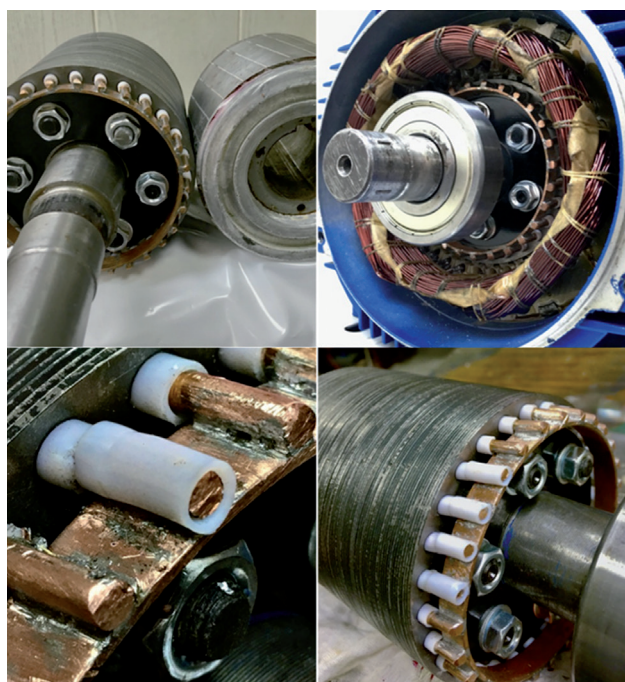
Рис. 2. Ротор экспериментального асинхронного двигателя Fig. 2. Rotor of an experimental induction motor
