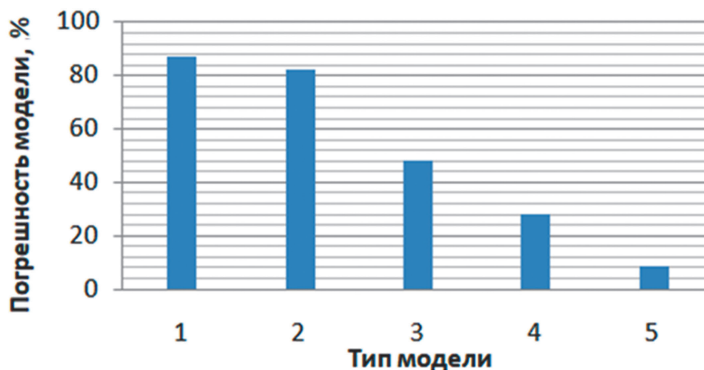
Рис. 3. Средняя погрешность моделей [18, 19]: 1 – модель «пространство состояний», 2 – модель «скользящее среднее»; 3 – спектральная модель; 4 – корреляционная модель; 5 – нейро-нечеткая модель
