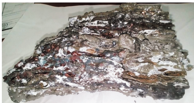
Рис. 1. Магматическая масса, приводящая к ошлакованию плавильной ванны при выплавке технического кремния в рудотермических печах [8]
