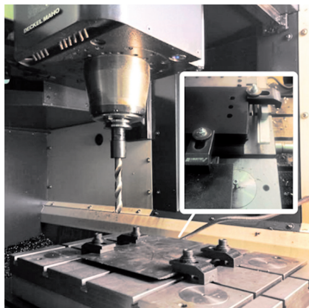
Рис. 4. Экспериментальная установка для определения осевой силы резания и крутящего момента при обработке смешанного пакета
