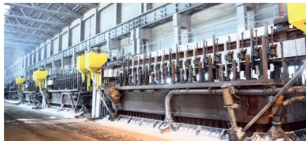
*Рис. 3. Электролизер С-8БМ(Э), оборудованный автоматической подачей глинозема и четырехкупольной системой газоудаления<sup>7</sup>*
