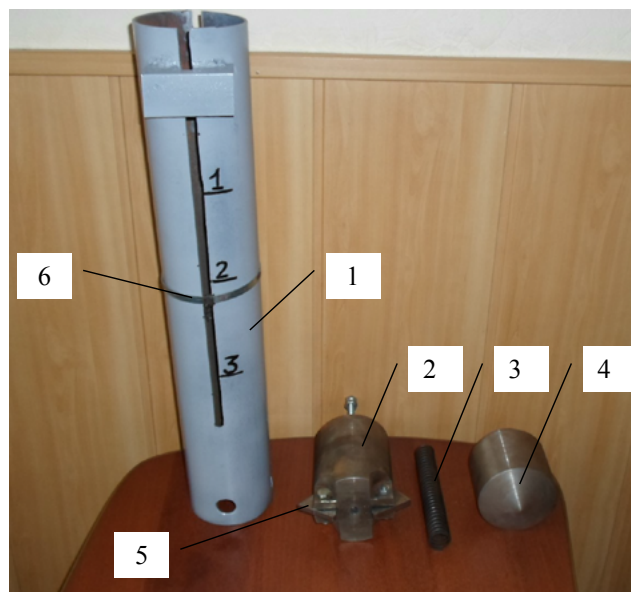
Рис. 1. Физическая модель ударного устройства: 1 – корпус; 2 – инерционная масса; 3 – упругий элемент; 4 – ударная часть; 5 – собачки; 6 – хомут Fig. 1. Physical model of the percussion device: 1 – case; 2 – inertial mass; 3 – elastic element; 4 – percussion part; 5 – catches; 6 – clamp
