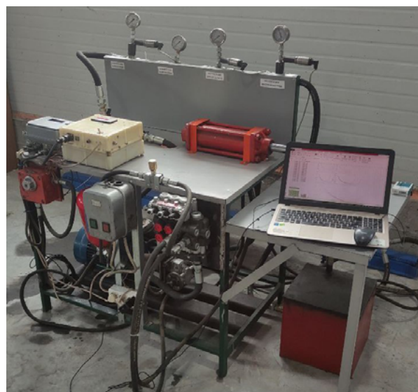
Рис. 5. Фотография стенда для исследования закрытой гидропередачи с аккумуляторным поддержанием избыточного давления во всасывающей линии насоса Fig. 5. An image of the test bench for the study of the closed hydraulic transmission with accumulator-supported overpressure in the pump suction line
