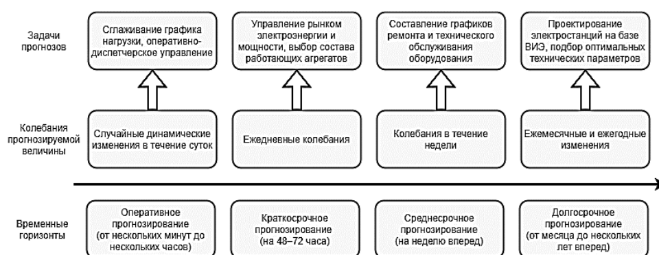
Классификация видов прогнозирования и их области применения Classification of forecasting types and their application areas
