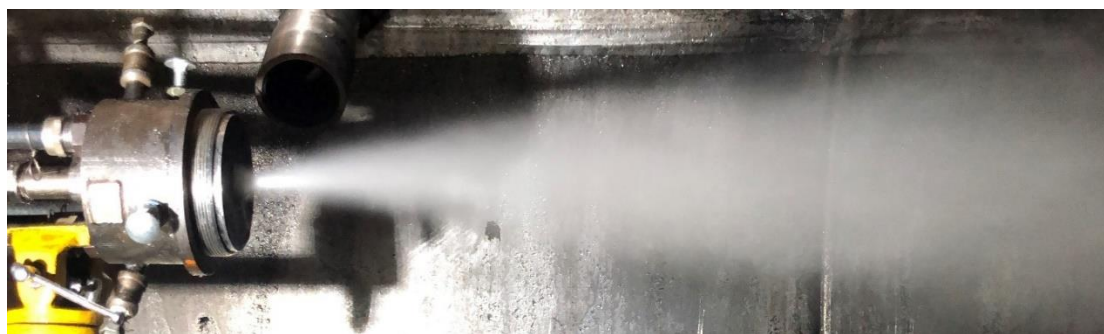
Рис. 7. Процесс распыления водоугольных суспензий Fig. 7. Spraying of coal-water slurries
